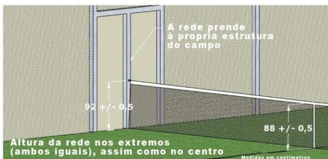
É suspensa por um cabo metálico de diâmetro máximo de 0,01 metros, cujas extremidades estão unidas a dois postes laterais de uma altura máxima de 1,05 metros ou à própria estrutura que as segura e lhe dão a devida tensão.
