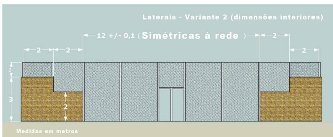
A malha metálica é sempre colocada e alinhada com a face interior das paredes.
